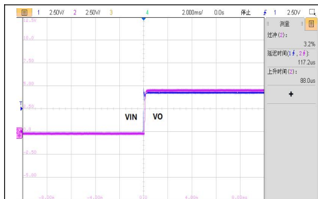
VIN=4.5V, 空载启机波形
