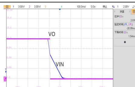
VIN=12V, 半载关机波形
