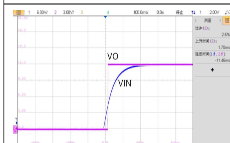
VIN=24V, 空载启机波形
