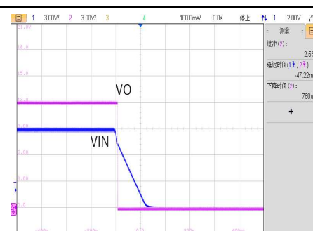
VIN=9V, 满载关机波形
