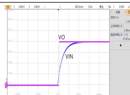
VIN=36V, 满载启机波形
