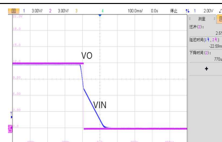
VIN=12V, 满载关机波形
