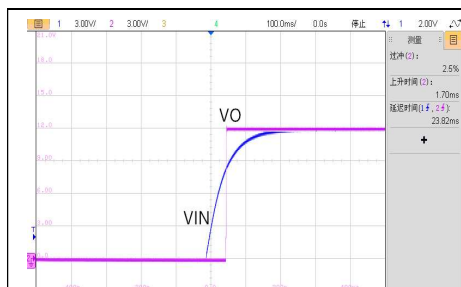
VIN=12V, 空载启机波形
