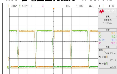
VIN=21.6V, 空载 VDS 波形
