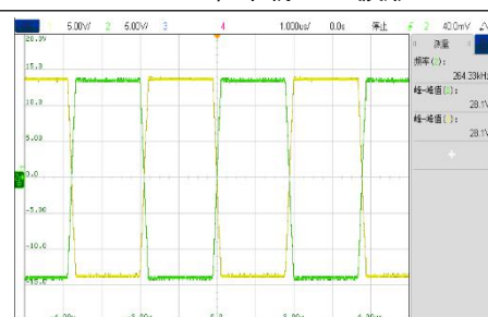
VIN=13.2V, 半载 VDS 波形
