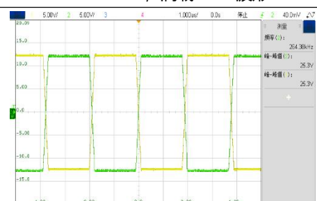
VIN=12V, 满载 VDS 波形
