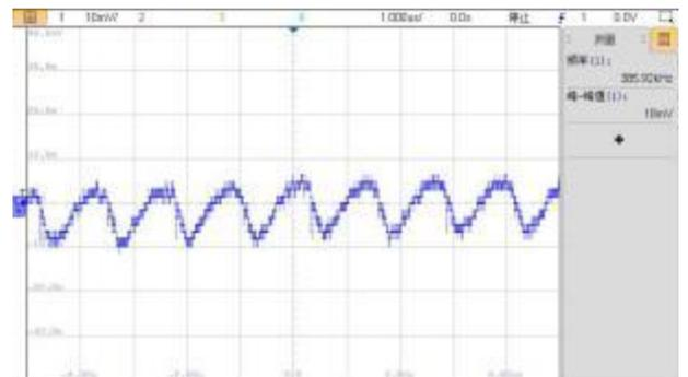
图 5: VIN=5V, 满载输出电压纹波波形
