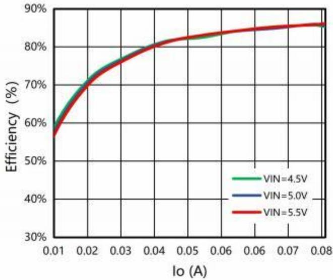
图 2: 效率 VS 输出电流
