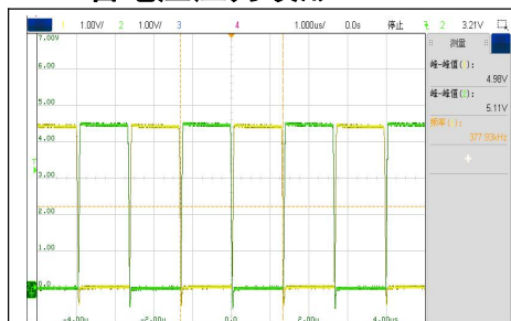
VIN=4.5V, 空载 VDS 波形
