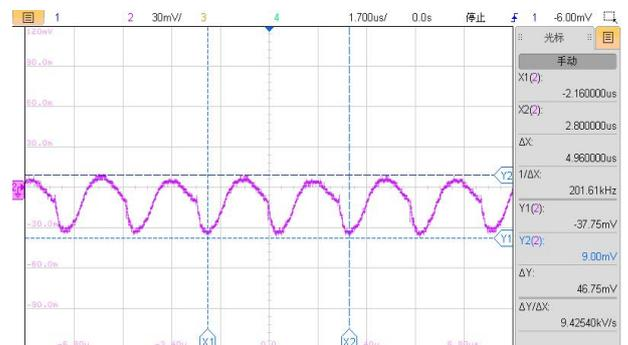
图 5: VIN=5V, 满载输出电压纹波波
