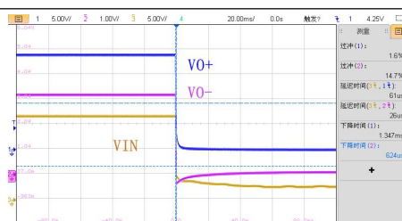
VIN=13.5V, 半载关机波形
