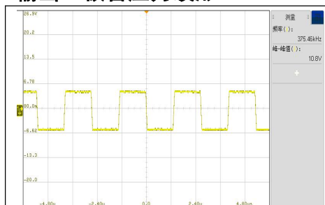
VIN=4.5V, 空载工作电压波形
