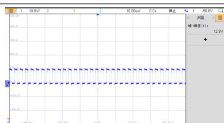
VIN=9V, 半载工作电压波形
