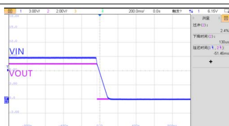
VIN=9V, 半载关机波形
