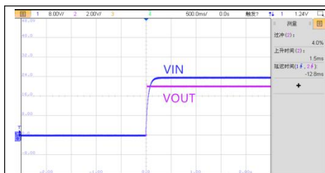
VIN=24V, 空载启机波形
