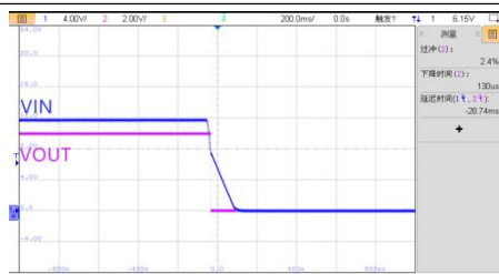
VIN=12V, 半载关机波形
