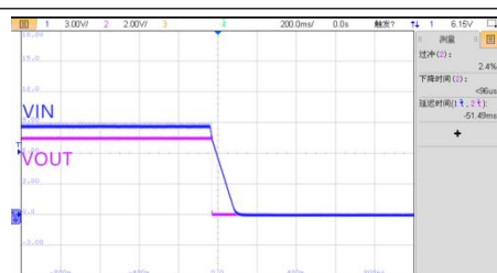
VIN=9V, 满载关机波形
