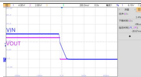
VIN=12V, 满载关机波形
