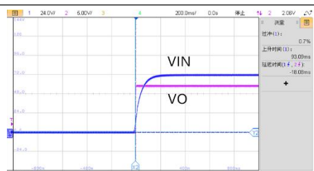
VIN=72V, 满载启机波形
