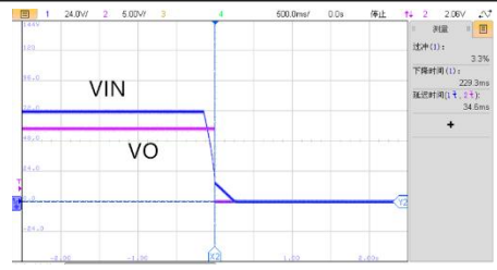
VIN=72V, 满载关机波形
