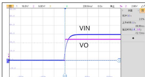
VIN=48V, 空载启机波形
