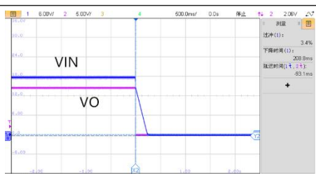
VIN=18V, 半载关机波形
