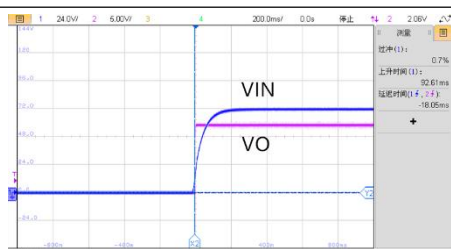
VIN=72V, 半载启机波形
