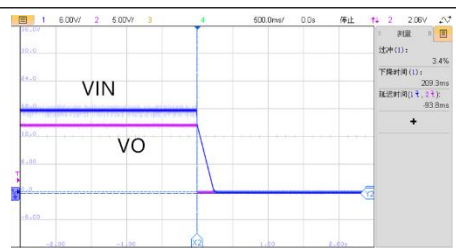
VIN=18V, 满载关机波形
