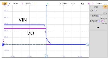
VIN=48V, 半载关机波形
