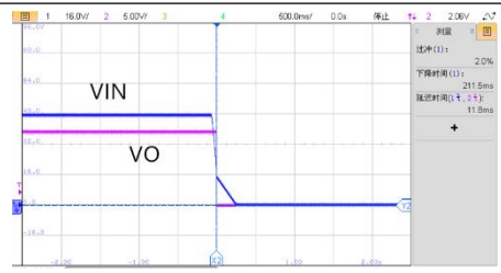
VIN=48V, 满载关机波形
