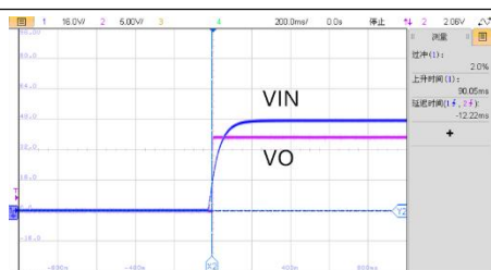
VIN=48V, 半载启机波形
