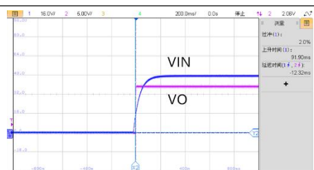
VIN=48V, 满载启机波形
