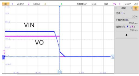
VIN=72V, 半载关机波形
