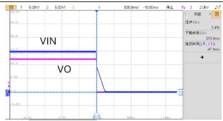
VIN=24V, 满载关机波形
