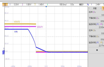
VIN=36V, 半载关机波形
