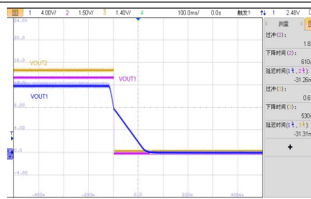
VIN=12V, 半载关机波形
