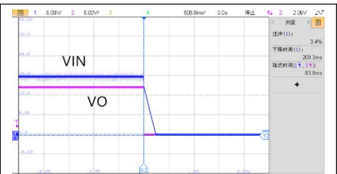
VIN=18V, 满载关机波形
