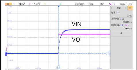
VIN=72V, 满载启机波形
