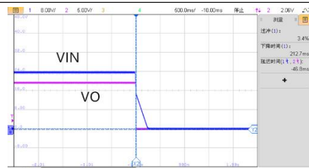
VIN=24V, 半载关机波形
