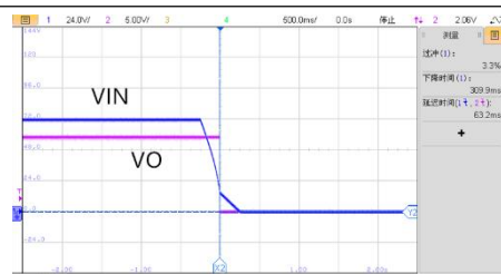
VIN=72V, 半载关机波形
