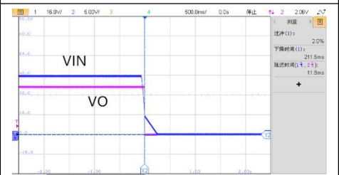
VIN=48V, 满载关机波形
