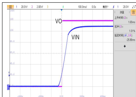
VIN=110V, 空载启机波形
