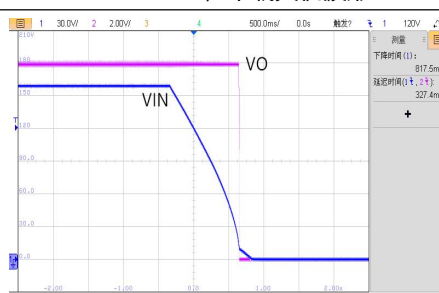
VIN=160V, 半载关机波形
