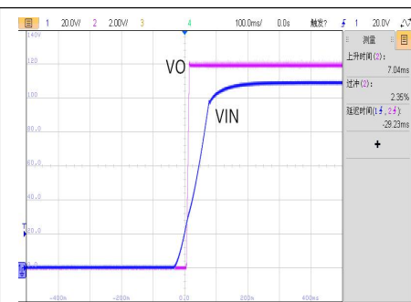
VIN=110V, 满载启机波形
