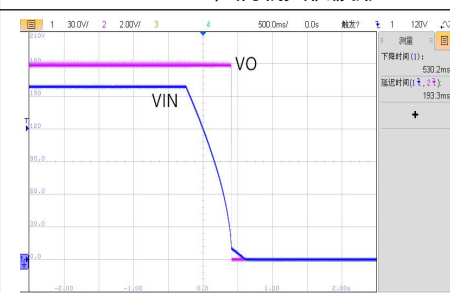
VIN=160V, 满载关机波形
