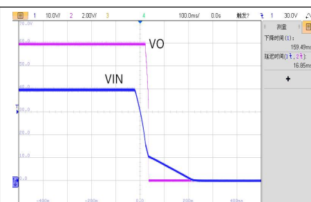
VIN=40V, 满载关机波形
