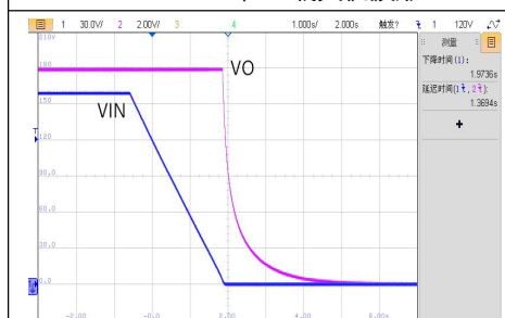
VIN=160V, 空载关机波形
