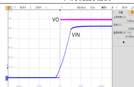
VIN=160V, 满载启机波形
