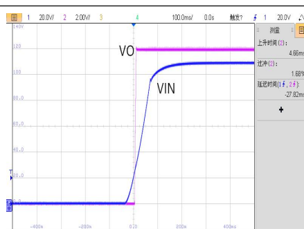
VIN=110V, 半载启机波形
