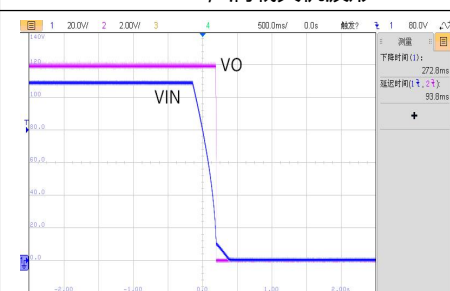
VIN=110V, 满载关机波形
