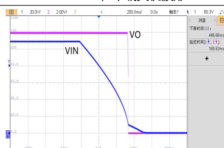
VIN=110V, 半载关机波形
